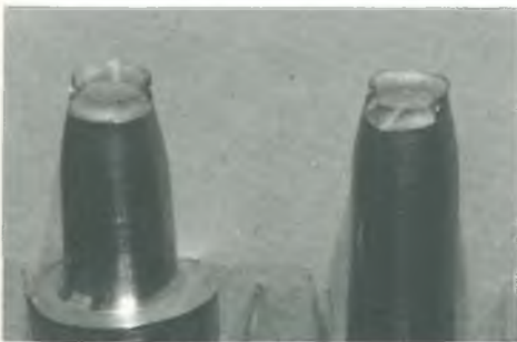
Figura 8 Fractura buena ductibilidad Copa B, bien formada
