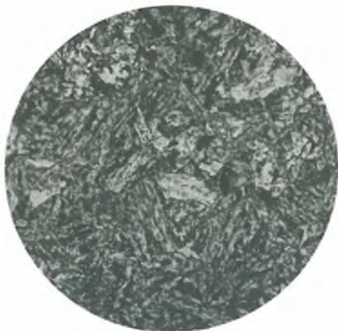
Figura 2 x 200 Estructura de acero laminado Ataque con nital 4
