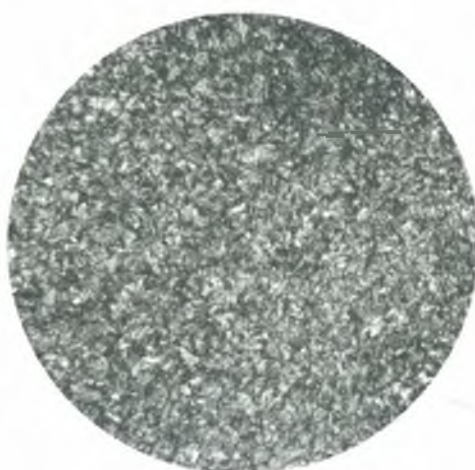
Figura 11 x 600 Estructura del revenido Constituyentes perlíticos
