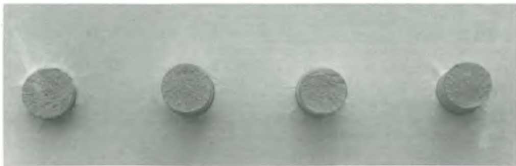
Figura 7 Barretas de tracción, fractura cristalina
