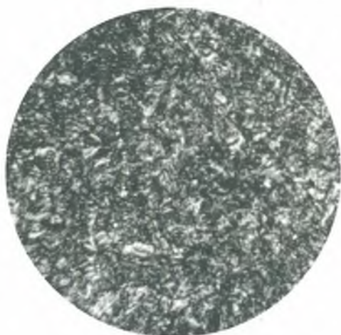
Figura 10 x 600 Estructura de temple Martensita
