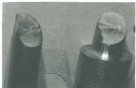
Figura 9 Copa pico flauta mala Defecto interno (Farra)
