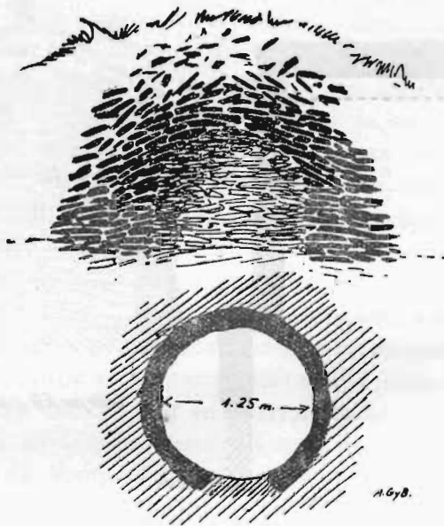
Cámara pequeña de Pendia cubierta con bóveda falsa.
