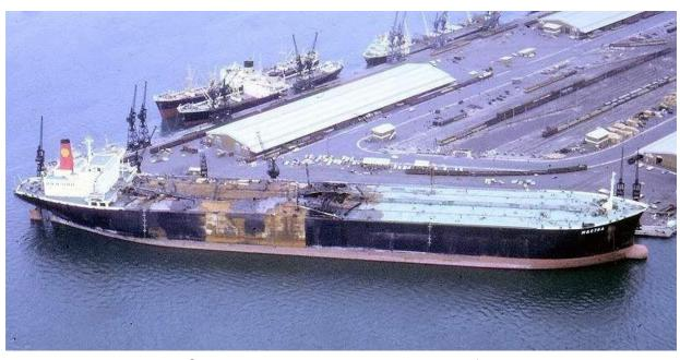
2. Buque petrolero tras una explosión en los tanques. <sup>4</sup>
