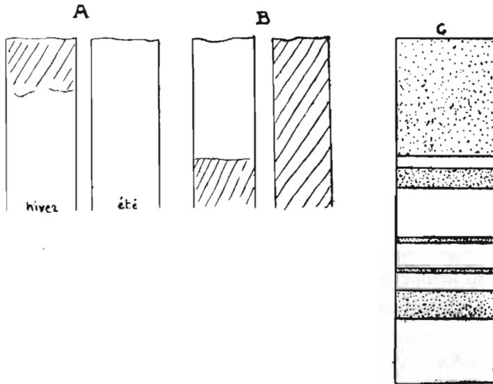
Figura 4.—Tipos de suelos helados.—A. Suelos afectados en la misma profundidad por los fenómenos del hielo y deshielo.—B. Suelos desigualmente afectados por los fenómenos de hielo y deshielo.—C. Suelo afectado por cambios estacionales, notables, que dan lugar a la presencia de capas no heladas entre dos heladas. En puntos y rayado las zonas heladas. (Tomado de J. Tricart).
