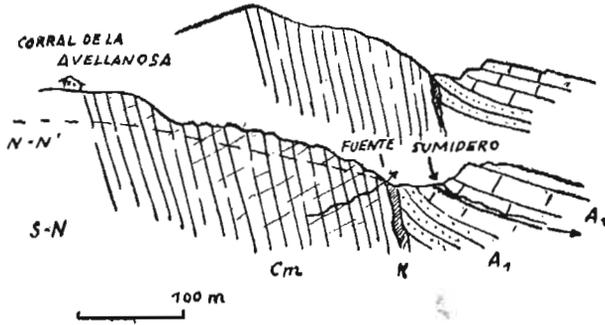
Fig. 6.—Corte hidrogeológico de la Fuente y Sumidero de la Avellanosa, ejemplo viviente de absorción carstica en el contacto cretácico caliza de montaña
