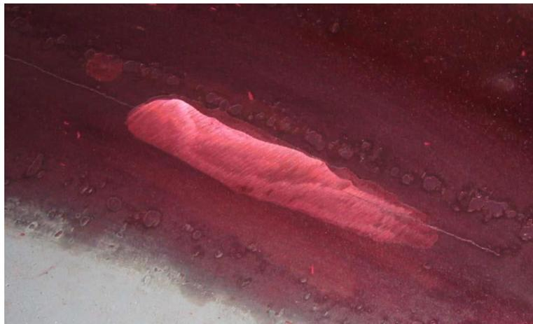
*Figura 1.7. Grieta de desbaste antes (extremos) y después (parte central) del amolado.*
