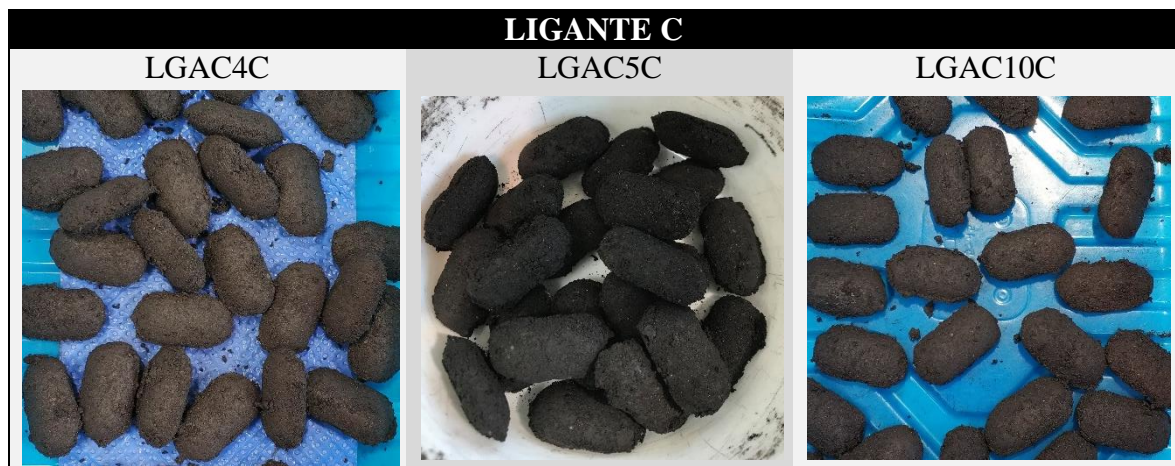
Figura 6.14.- Experimento 2. Briquetas fabricadas a partir de las mezclas LGA + LGB + 10%AC (5-6% humedad) con el ligante C.
