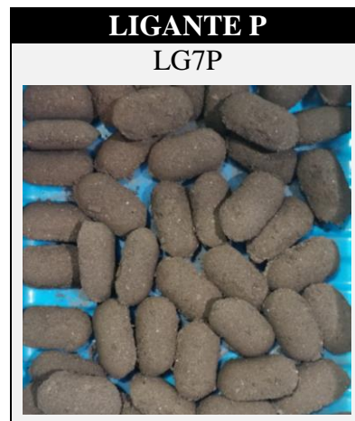
Figura 6.7.- Experimento 1. Briquetas fabricadas a partir de las mezclas LGA + LGB (5% humedad) con el ligante P.
