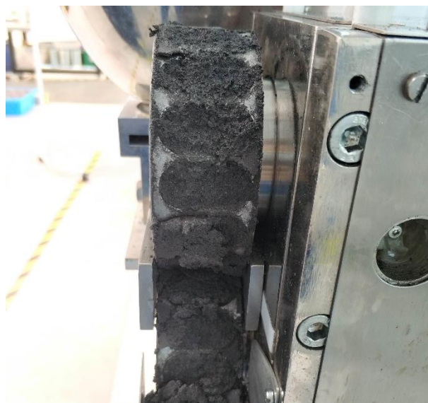
Figura 5.9.- Resultado del proceso de briqueteado con un par del rodillo demasiado alto.
