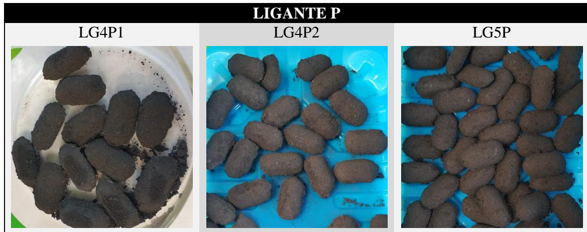
Figura 6.1 (continuación).- Experimento 1. Briquetas fabricadas a partir de las mezclas LGA + LGB (6-7% humedad) con el ligante P.
