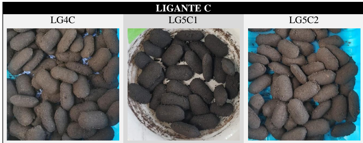
Figura 6.2.- Experimento 1. Briquetas fabricadas a partir de las mezclas LGA + LGB (6-7% humedad) con el ligante C.
