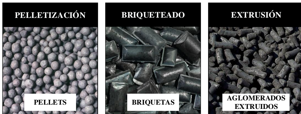
Figura 2.12.- Principales procesos de aglomeración de residuos siderúrgicos [9], [10], [11].
