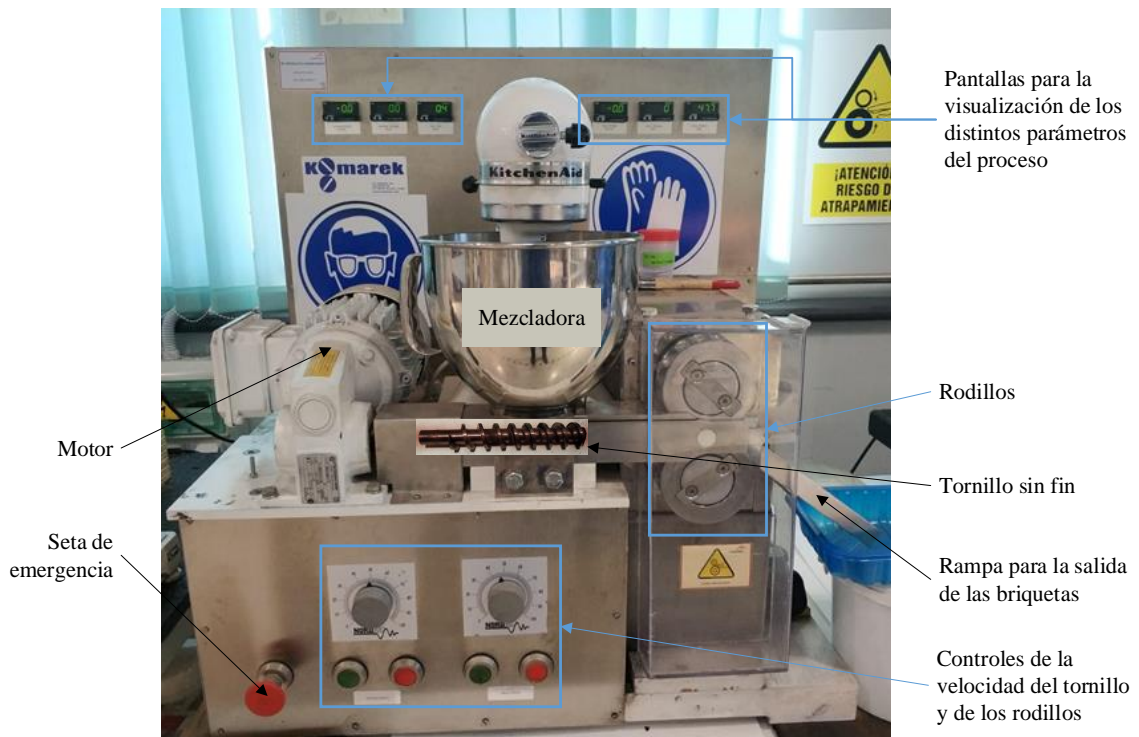
Figura 5.3.- Equipo empleado para la fabricación de las briquetas con sus partes principales.
