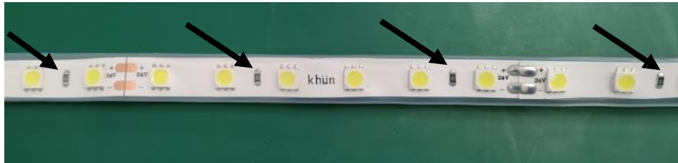
Figura 12.9.- Tira LED alimentada a 24V a tensión constante con ecualizadores señalados.
