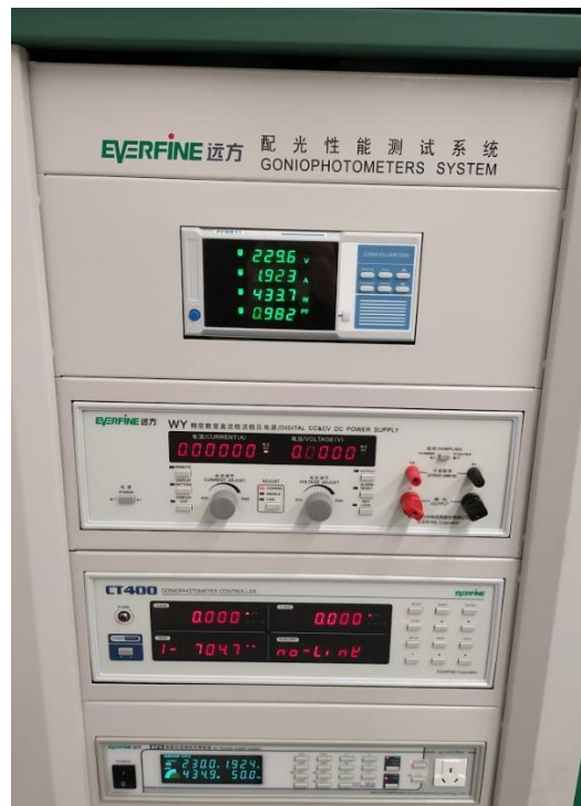
Figura E.20.- Monitorización de variables eléctricas durante el ensayo fotométrico.
