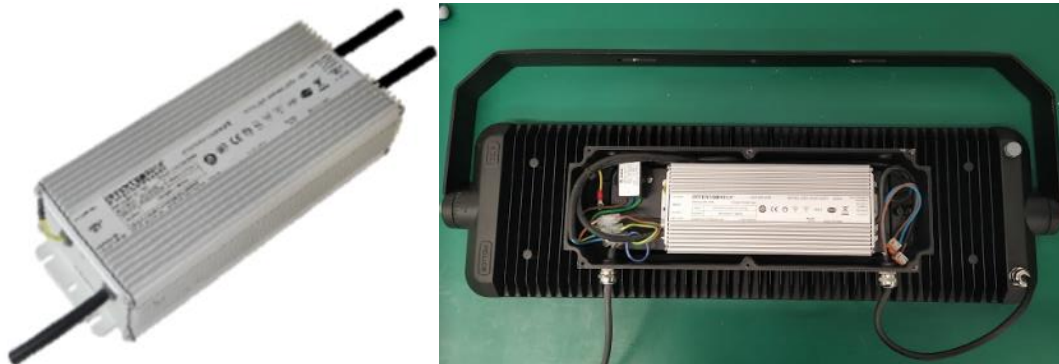
Figura 7.10.- Modelo del driver EBC-430S140DV(SV) de la marca Inventronics utilizado en los módulos de los proyectores Tapia ensamblado.
