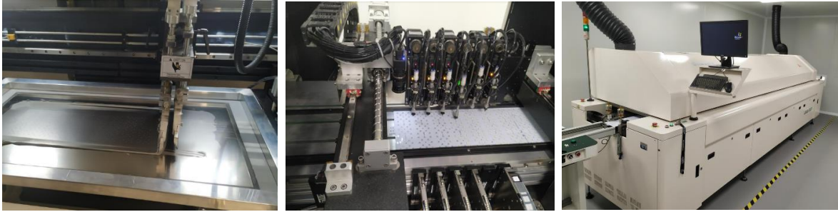
Figura 7.6.- Proceso de montaje del módulo LED: (1) aplicación de pasta de soldadura, (2) colocación componentes sobre placa y (3) horno de convección.
