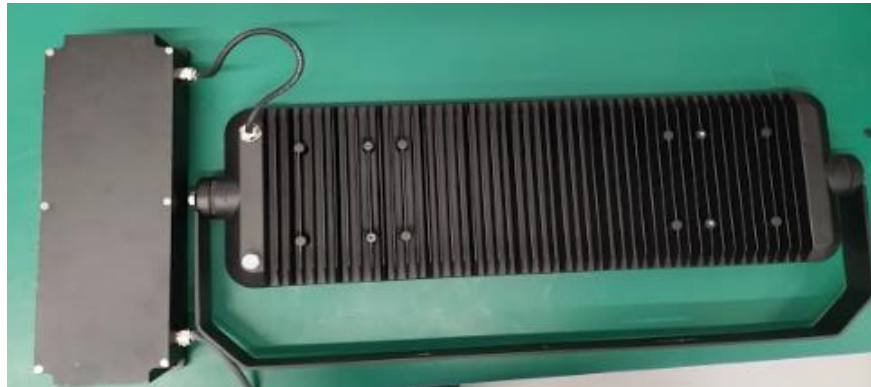
Figura 7.9.- Carcasa del proyector Tapia y compartimento independiente del driver.
