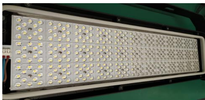
Figura 7.8.- PCB del proyector Tapia de un módulo ensamblado en la carcasa con lentes.
