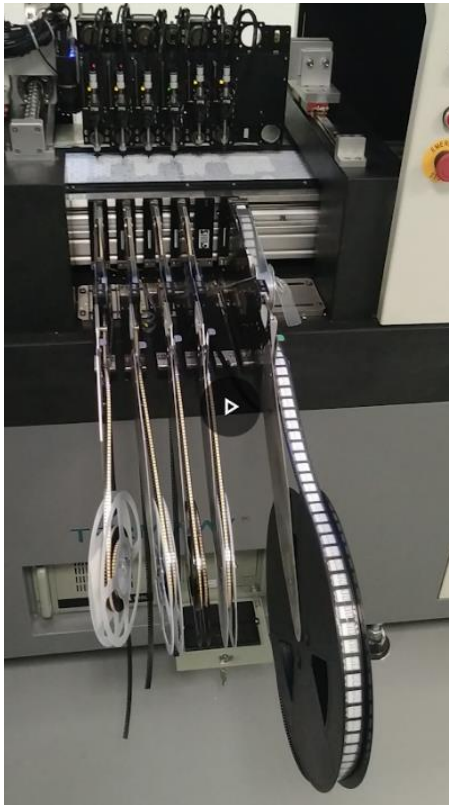
Figura E.2.- Máquina "Pick and place" colocando los chips LED en la placa PCB.
