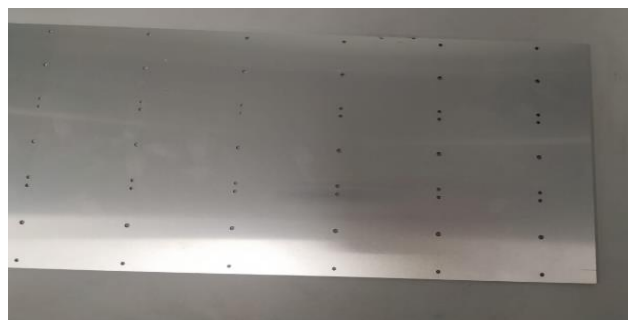
Figura 7.1.- Material seleccionado para la fabricación del PCB (placa MCPCB de Aluminio).
