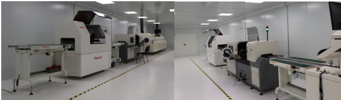
Figura 7.5.- Maquinaria del sistema SMT con el que se realiza el montaje del módulo.
