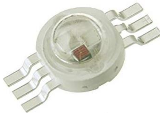
Figura A.3.- Imagen de un chip LED de tecnología RGB, con terminales eléctricos independientes para cada núcleo del chip.
