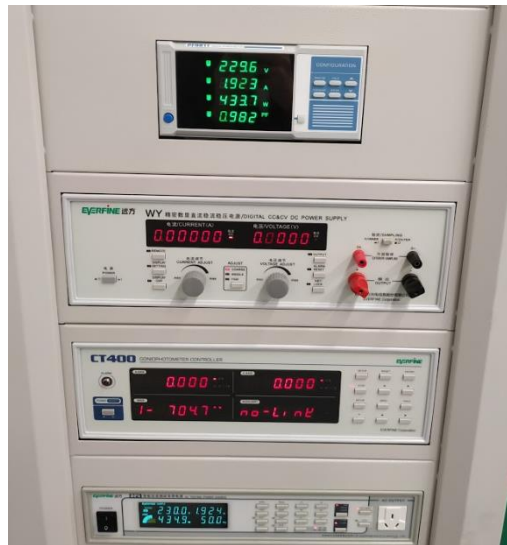
Figura E.25.- Monitorización de variables eléctricas en la esfera integradora.
