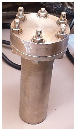
Figura 57. Autoclave individual utilizada en la síntesis de la CuBeta_23.
