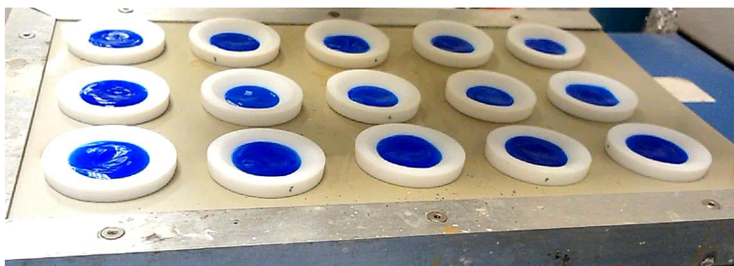
Figura 45. Multiautoclave con 15 mezclas de reactivos diferentes.
