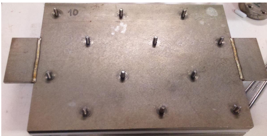
Figura 46. Multiautoclave completamente sellado.
