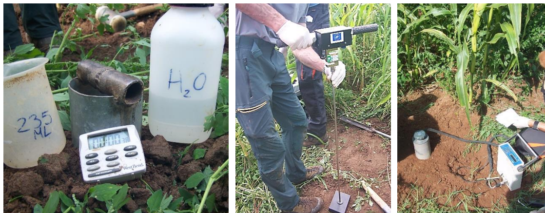
Fotografía 5.3. Material utilizado para la medida del tiempo de infiltración (izquierda), compactación (centro) y emisión de CO 2 (derecha) del suelo según los protocolos descritos en las Tarjetas de Salud de los Agroecosistemas Pascícolas (TSAP).
