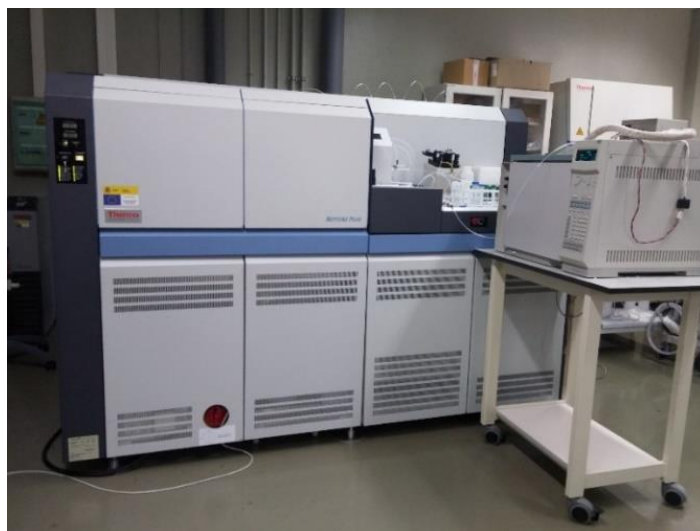
Figura C.6. Imagen del GC acoplado al MC-ICP-MS (Neptune Plus)
