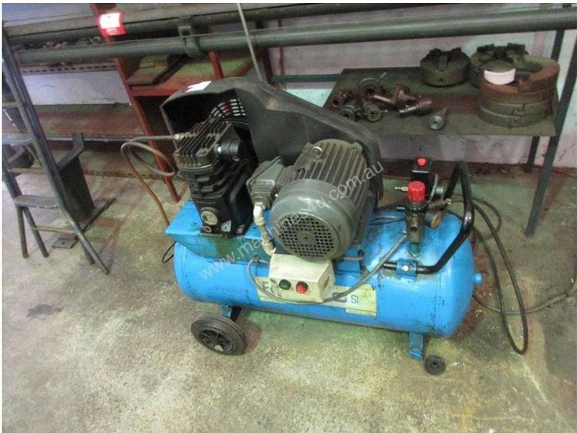
Figura 26: Compresor de aire limpio de a bordo
