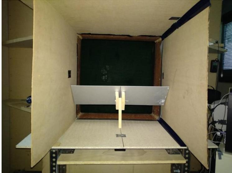
Figura 37. Modelo 2 montado en la sección de prueba del túnel B)
