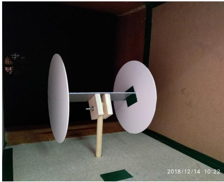
*Figura 40. Modelo 3 montado en la sección de prueba del túnel B)*
