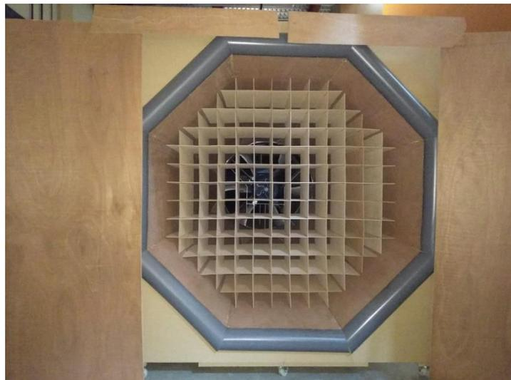
*Figura 31. Vista posterior ventilador (túnel B)*
