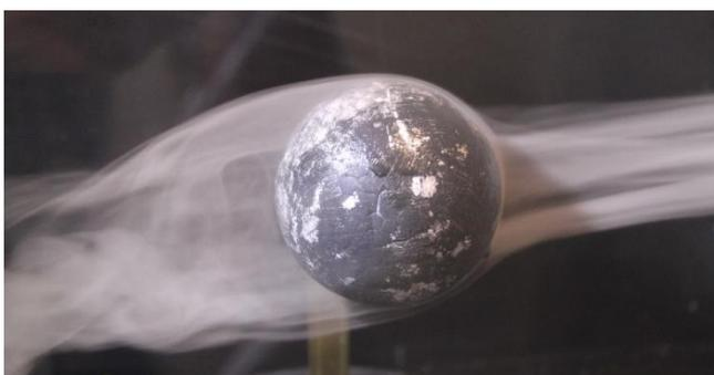
Figura 11: Desprendimiento de capa límite para una  $v=0,6$  m/s y un diámetro de la esfera de 55 mm
