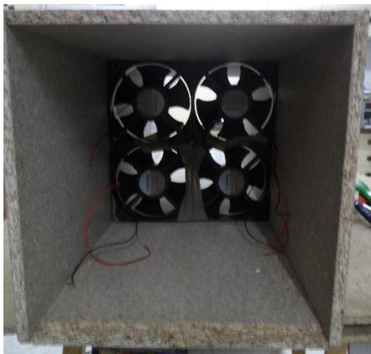
Figura 2: Disposición de la matriz de ventiladores
