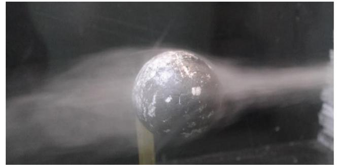
Figura 12: Desprendimiento de capa límite para una  $v=1$  m/s y un diámetro de la esfera de 55 mm
