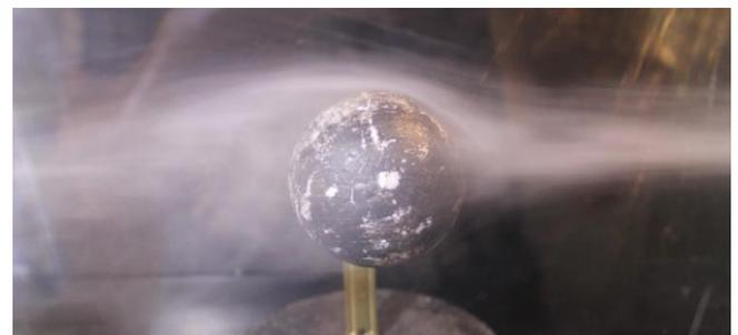
Figura 13: Desprendimiento de capa límite para una  $v=1,5$  m/s y un diámetro de la esfera de 55 mm
