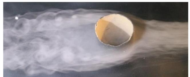
Figura 14 y 15: Desprendimiento de vórtices para una  $v=0,5$  m/s y un diámetro de cilindro de 40 mm
