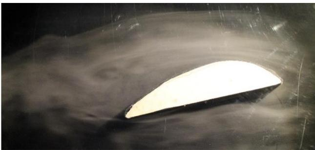
Figura 17: Perfil alar Velocidad  $v=0.5$  m/s. Longitud 100 mm, ancho 40 mm.
