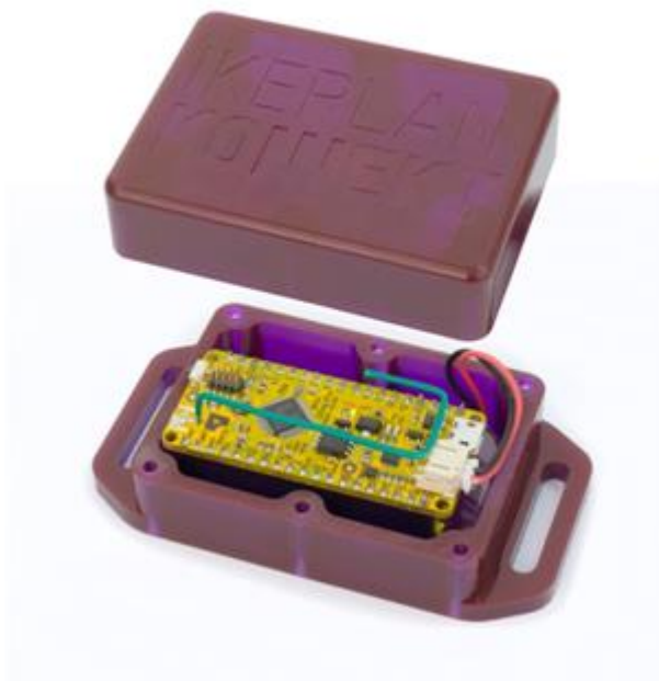
Figura 56 Vista interna del nodo sensor 1
