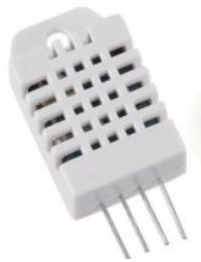
Figura 19 Sensor de humedad y temperatura DTH22
