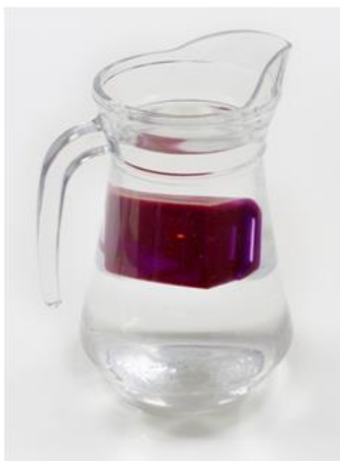
Figura 57 Nodo sumergido en agua por 30 min
