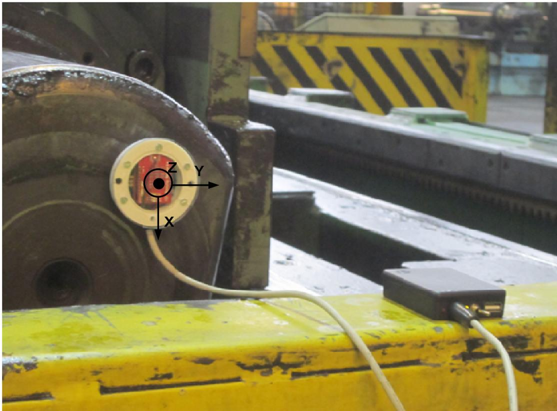
Imagen 14: Detalle de la colocación del sensor en la toma de datos.
