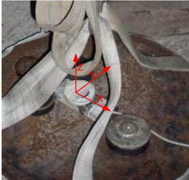
Imagen 21: Detalle de cómo quedan los ejes del acelerómetro en el experimento 3.
