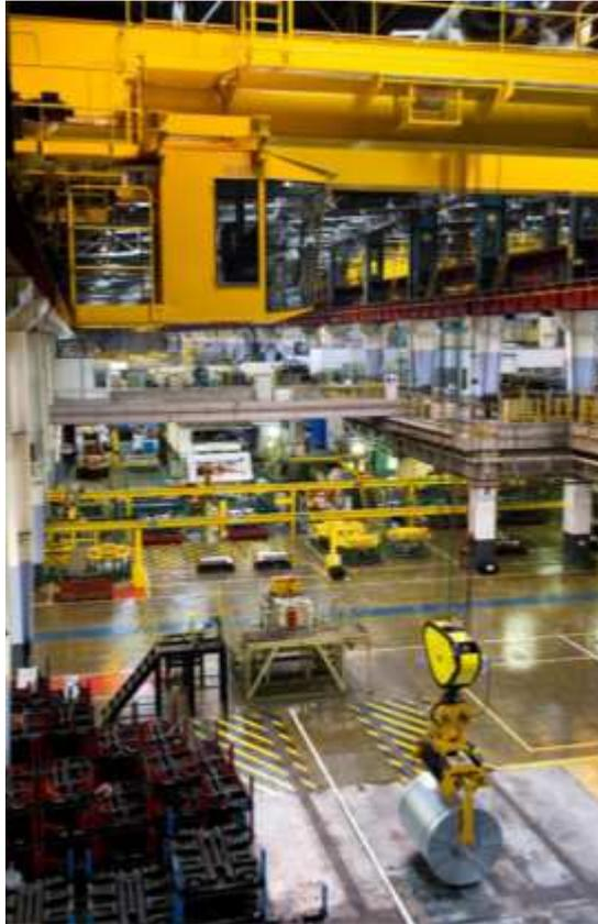
Imagen 4: Manipulación de las bobinas dentro del parque. Imagen extraída del libro virtual “El proceso siderúrgico.”
