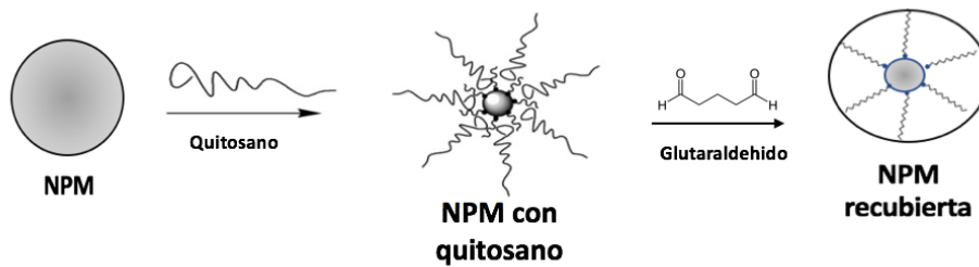
Figura 19. Representación esquemática del recubrimiento con quitosano y glutaraldehído.
