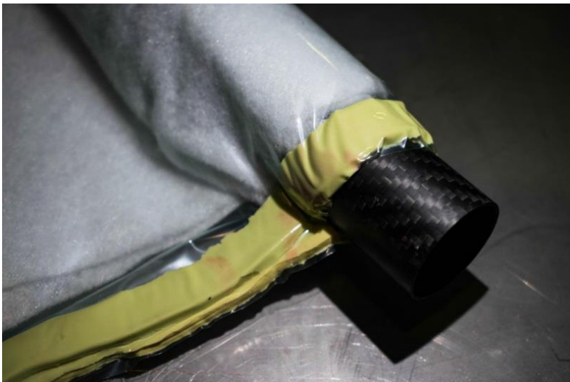
Ilustración 5. Sellado del conjunto
