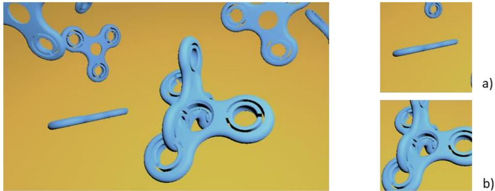
**Figura 12. Problemas derivados de la colocación aleatoria en el espacio. a) Poses desde las que no se aprecia la geometría del spinner. b) Intersección entre cuerpos.**
