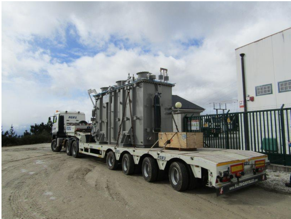
Figura 7.6 Transporte en camión del transformador de potencia
