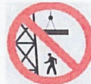
Prohibido permanecer en el área de descarga
