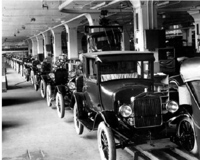
Figura 3.2.-Construcción seriada de vehículos de combustión interna en la segunda revolución industrial. [5]
