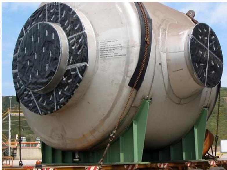
Figura 2.1.- Intercambiador de calor de acero fabricado en las instalaciones de Mefasa[1].
