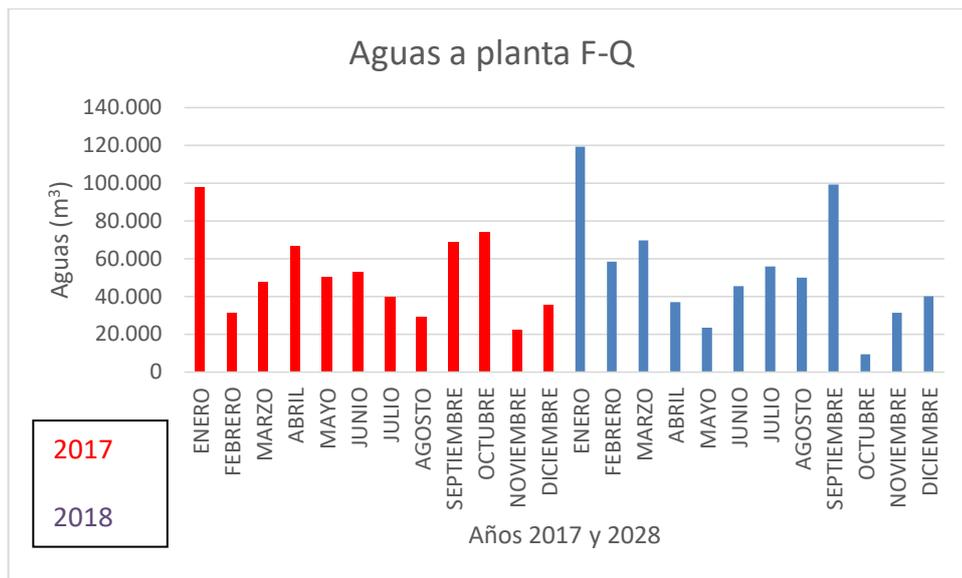
Imagen 16. Salidas de planta: aguas a planta físico-química. Fuente: Autor
