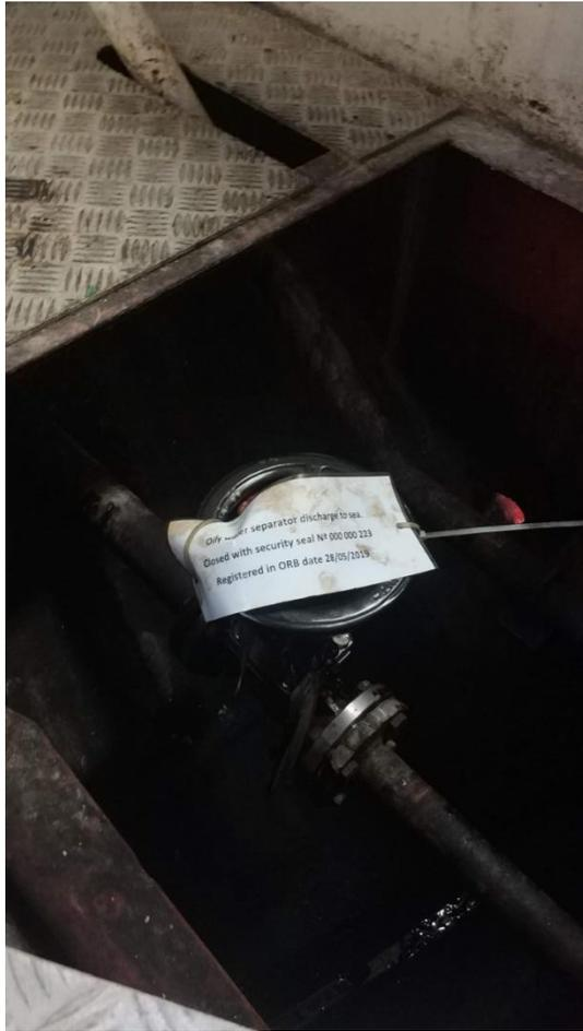
**Imagen 20. Válvula de descarga al mar del buque Ro-Pax Napoles. Fuente: Autor**
