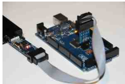
Ilustración 209 Conexión del Programador ISP al Arduino Mega
