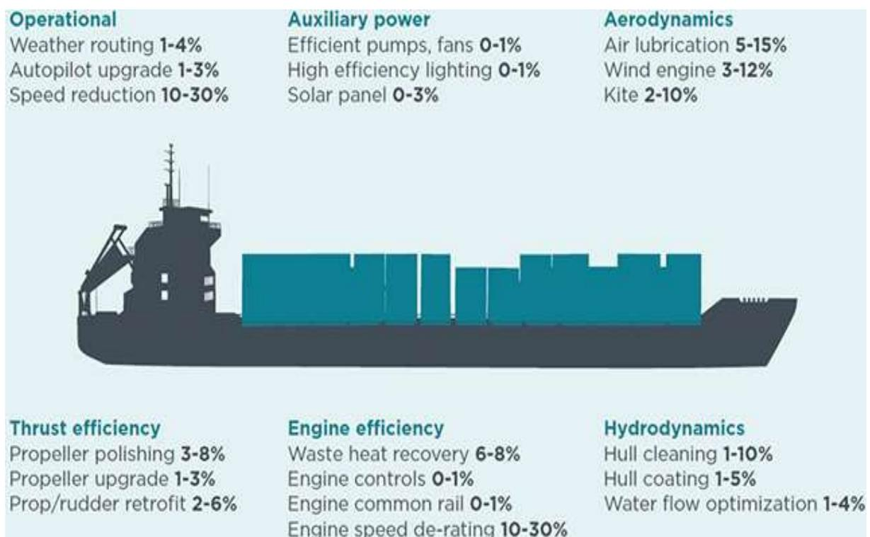
Imagen 2.-El combustible y las reducciones de CO<sub>2</sub> con varios enfoques de eficiencia para los buques.
