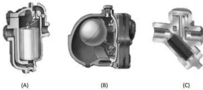
Ilustración 11. Trampas de vapor A) Mecánica; B) Termostática; C) Termodinámica. (Fuente QuimiNet, 2012)
