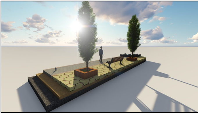
Figura 2 Detalle del pavimento permeable diseñado para el Paseo del Bombé en el Campo San Francisco. Fuente: elaboración propia.
