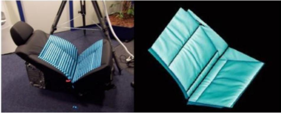
Figura 8. Reconstrucción de un sillón con proyección de luz estructurada.
