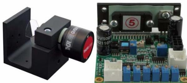
Figura 26. Galvo y driver del motor.
