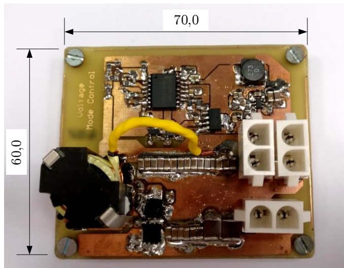
Figura 3.46: Prototipo del reductor síncrono controlado en modo tensión con dos MOSFETs TPH7R006PL, un núcleo RM8 en material N97 y un \Delta i_L de un 40 %.
