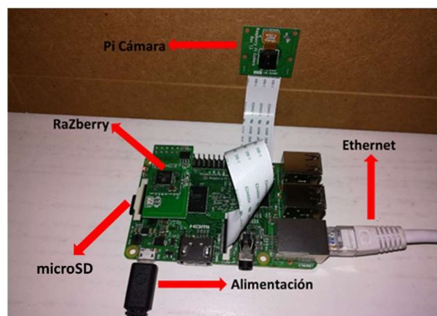
Figura 3.1.- Montaje completo del controlador.
