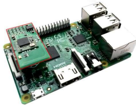
Figura 2.6.- Raspberry Pi + RaZberry (rodeada de rojo) [16].
