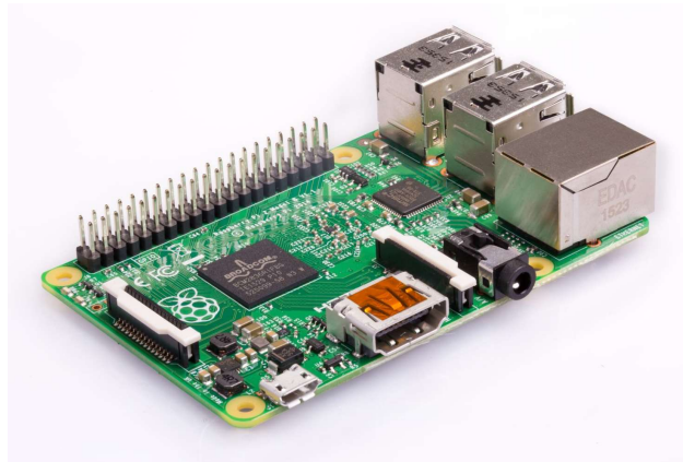
Figura 2.5.- Placa Raspberry Pi [13].
