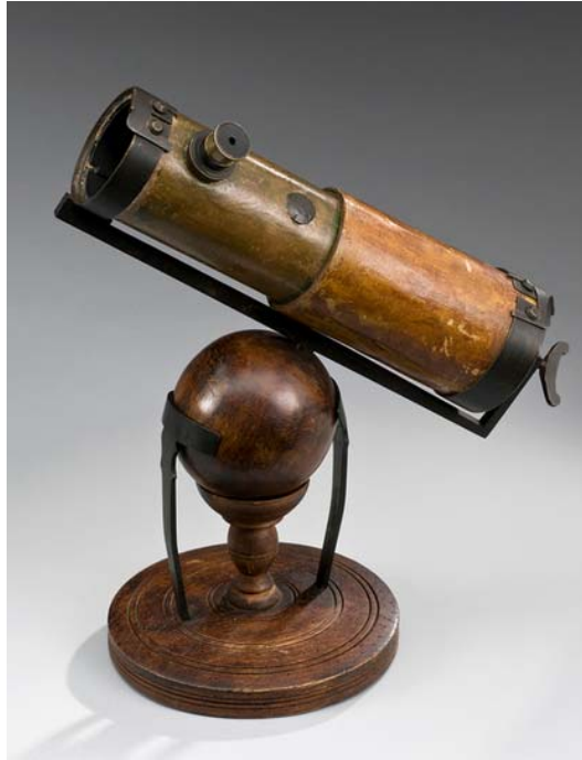
Figura 10.- Primer telescopio reflector construido por Isaac Newton, presentado en la Royal Society en 1671.
