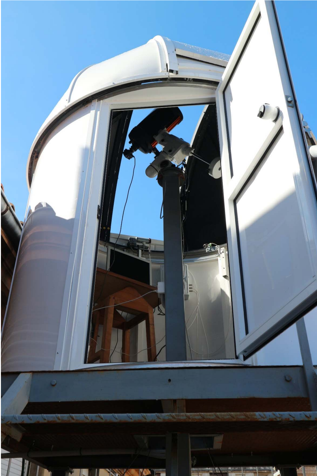
Figura 39.- Cúpula abierta con vista del telescopio catadióptrico y montura ecuatorial
