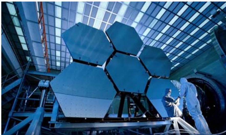
Figura 14.- Ingenieros trabajando en uno de los 18 segmentos que conformarán el espejo primario del telescopio espacial James Webb.
