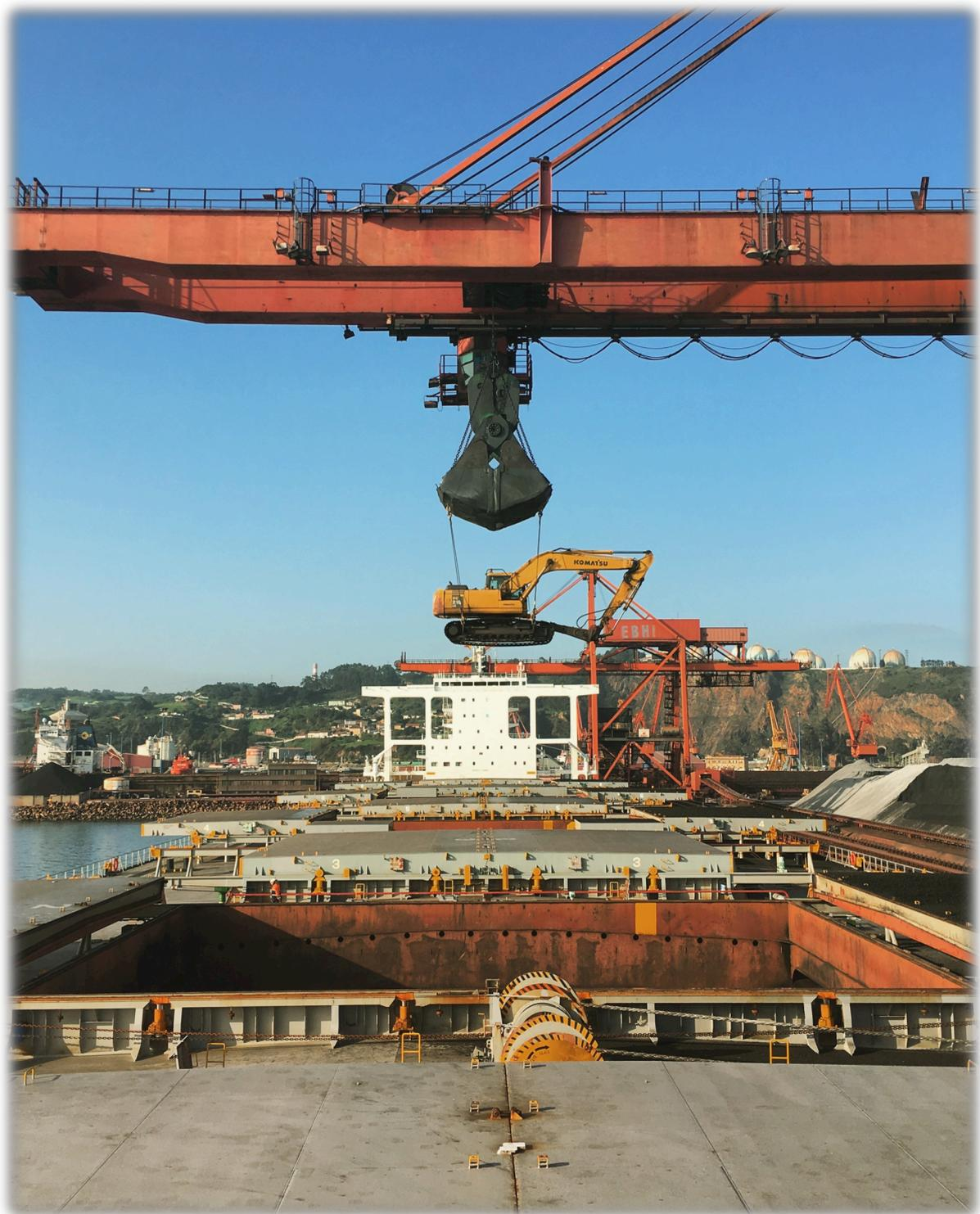
Figura 57. Grúa pórtico introduciendo una retropala con martillo neumático en la bodega de un granelero.
