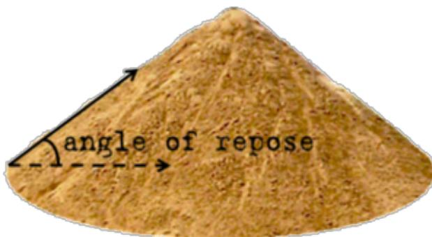
**Figura 9. Ángulo de reposo en una pila de grano.**
