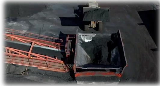
**Figura 55. Excavadora cebando una cinta transportadora a través de una tolva pequeña**
