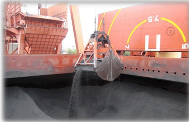
**Figura 2. Descarga de carbón de un buque granelero**
