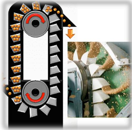
Figura 40. Diagrama de funcionamiento.
