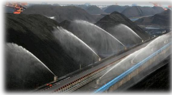
Figura 30. Pilas de carbón rociadas con agua.
