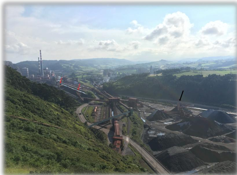
**Figura 56. Explanada de Aboño, marcadas con flechas rojas las dos apiladoras y con flecha negra la rotopala.**
