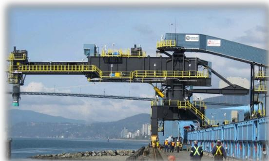
Figura 42. Cargador con tolva telescópica.
