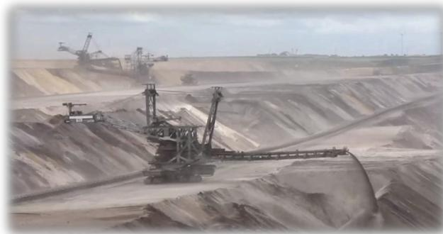
Figura 32. Apilador en funcionamiento en una mina a cielo abierto.
