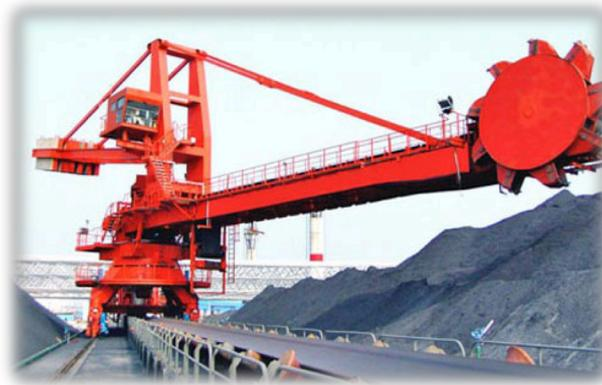
**Figura 33. Rotopala actuando de recuperador sobre railes en unas pilas de carbón.**
