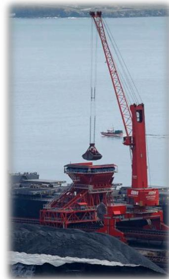
**Figura 53. Grúa móvil descargando en la tolva ecológica.**
