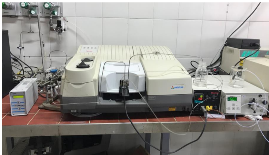
Figura 3.5 Equipo experimental completo de utilizado en los ensayos de espectroscopía DRIFT
