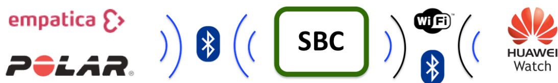
Fig. 4.47.- Esquema de la interconexión entre los distintos dispositivos wearables y la SBC del sistema central embarcado.
