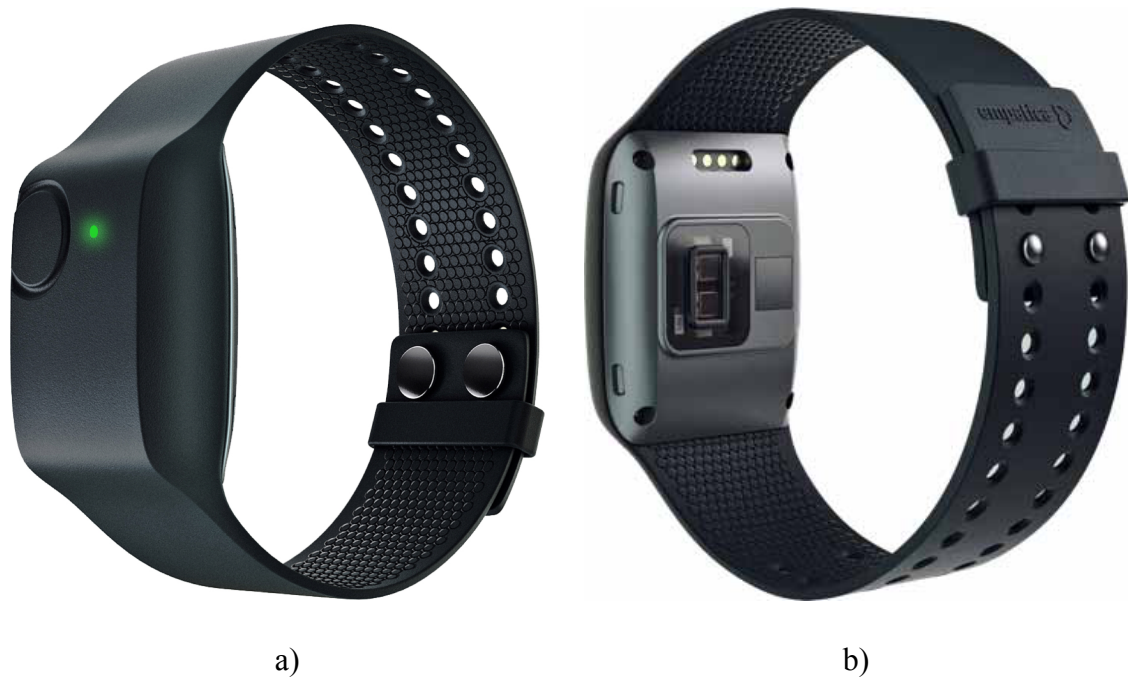
Fig. 4.46.- Pulsera de actividad Empatica E4 empleada para adquisición de datos biométricos muy fiables, precisos y con certificados de calidad. Vista delantera (a) y trasera (b).
