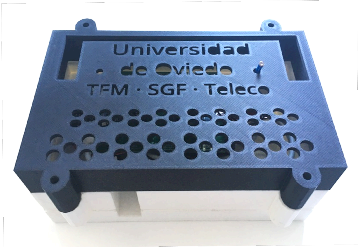
Fig. 4.43.- Prototipo final basado en TS PCB colocado dentro del encapsulado impreso en impresión 3D. Todas las conexiones internas han sido realizadas y el prototipo sólo dispone de un interfaz con el exterior a través del hueco rectangular visible en la base (parte blanca) del encapsulado a través del cual se conectaría la alimentación mediante un cable micro-USB.
