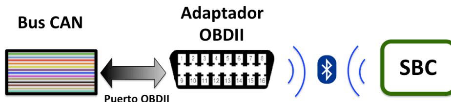
Fig. 4.48.- Esquema de la interconexión entre los distintos elementos que intervienen en la adquisición de datos del mecánicos del vehículo.
