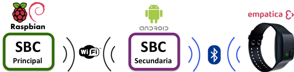
Fig. 5.7.- Esquema básico de la transmisión de datos y las interconexiones entre los diferentes dispositivos para la adquisición y almacenamiento de datos biométricos con pulsera Empatica E4 .
