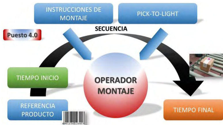
Figura 1 Esquema básico del Puesto 4.0.: registro automático de tiempos, personas y productos. Secuenciado de pick-to-light (piking) con las instrucciones de montaje.
