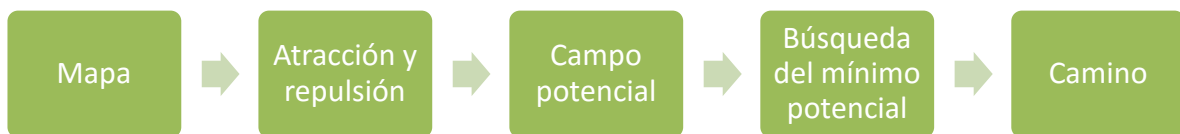
Figura 2.137. Esquemmatización de la planificación de trayectorias mediante campos potenciales.
