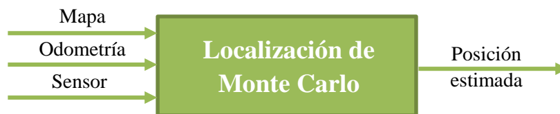
Figura 3.3. Inputs y output de la localización de Monte Carlo.
