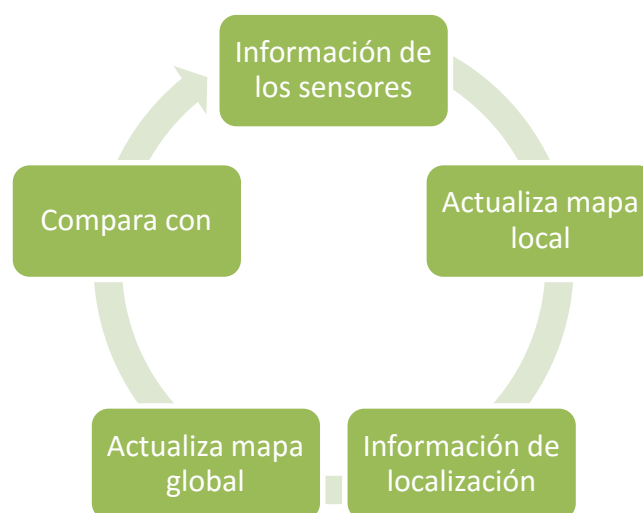
Figura 3.2. Estructura del algoritmo de mapeo mediante ocupación de celdillas.
