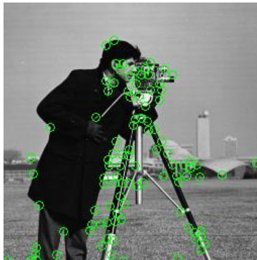
Figura 2.15. Detección de esquinas mediante el método de Kanade-Tomasi [25].
