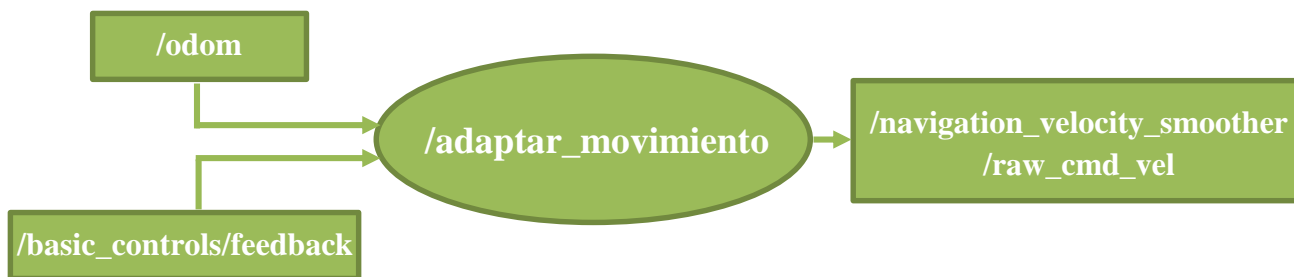
Figura 4.16. Esquema de comunicación entre el nodo y los tópicos para la adaptación de movimientos.
