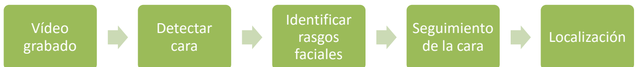
Figura 3.4. Esquema del método utilizado en la localización de la persona.
