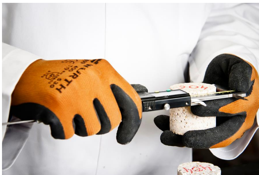
Ilustración 4.15: comprobación diámetro probetas
