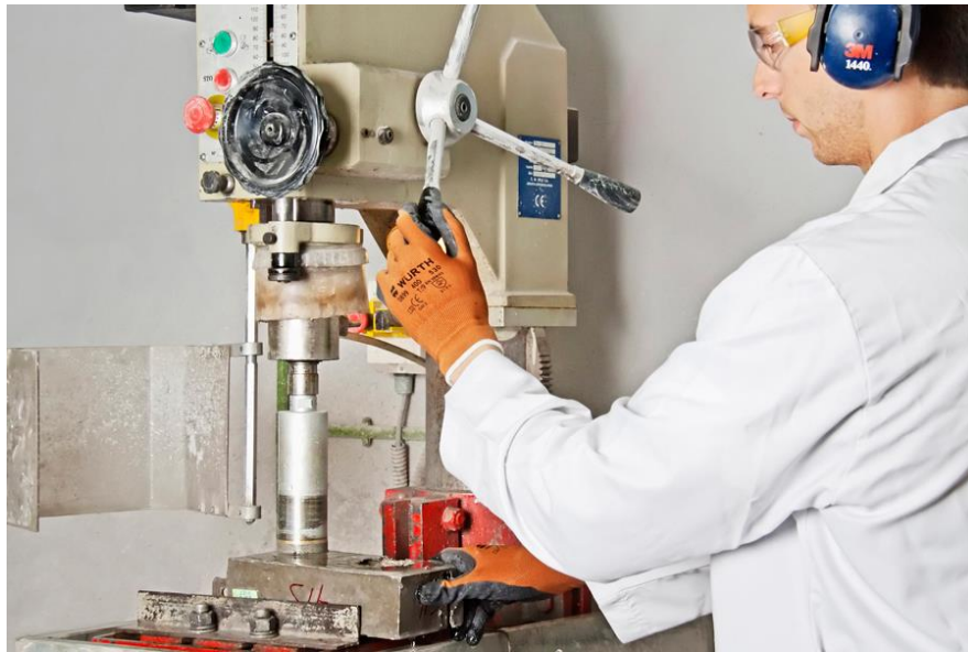
Ilustración 4.9: proceso obtención de probetas
