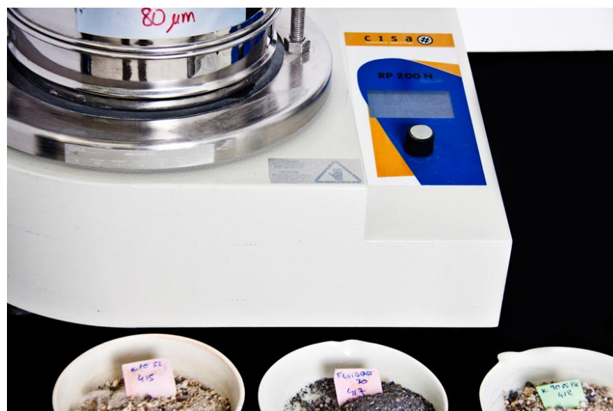
Ilustración 4.1: muestras y tamizadora electromecánica.
