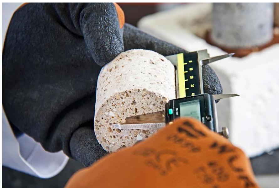
Ilustración 4.14: comprobación altura de probetas
