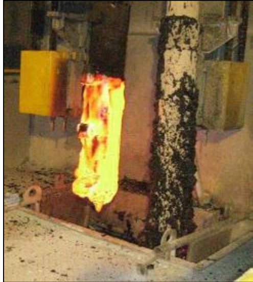
Figura 19: Lanza de inyección de sílice (CSC)
