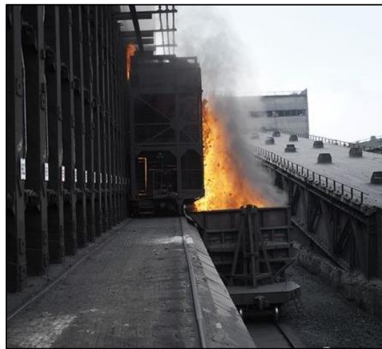
Figura 4: Proceso de deshornado del coque
