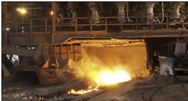
Figura 5: Sangrado del horno alto – piquera
