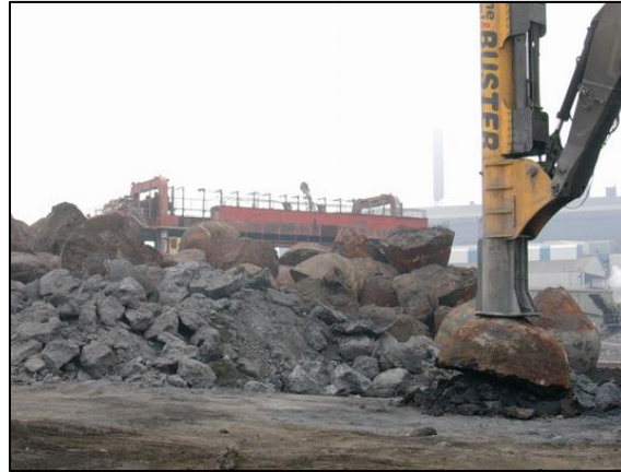
Figura 14: Proceso de trituración de las escorias solidificadas. FUENTE: http://fractum.com/industries/steel-industries/slag-pot-deskulling/
