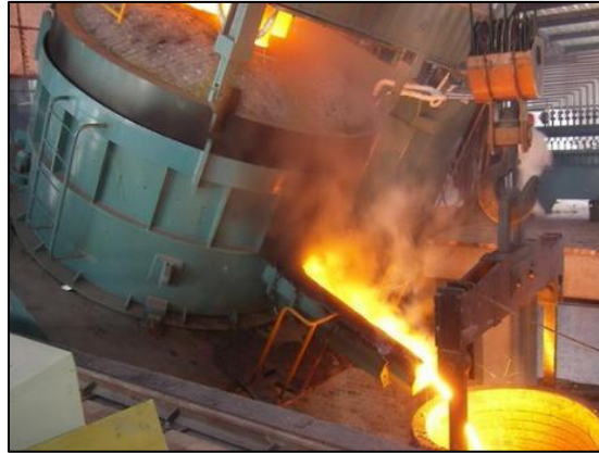
Figura 8: Volcado de acero líquido del horno eléctrico.
