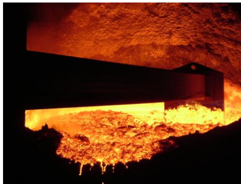
Figura 10: Proceso de skimming de la escoria de desulfuración FUENTE: http://www.kuettner.com/Default.aspx?ID=545
