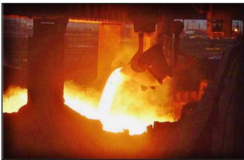
Figura 15: Volcado de escorias en foso (izquierda) y regado de escorias con agua (derecha) FUENTES: http://buildindustrialpakistan.blogspot.com/2014/03/ld-converter-slag-disposal-facilities.html y https://www.hennlich-engineering.com/applications/fog-cannons/steel-slag.html
