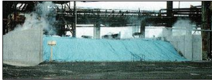
Figura 17: Proceso de estabilización por vapor en Kokura Works desarrollado en 1992
