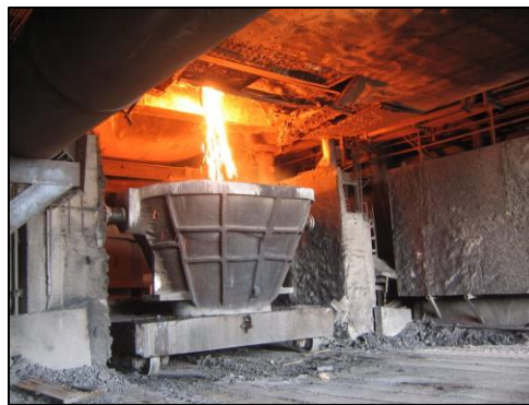
Figura 13: Volcado de escoria en cuchara FUENTE: http://mapio.net/pic/p-24952401/
