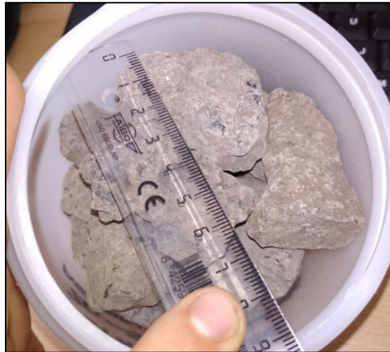
Figura 26: Detalle de forma de caras en las escorias de acería.
