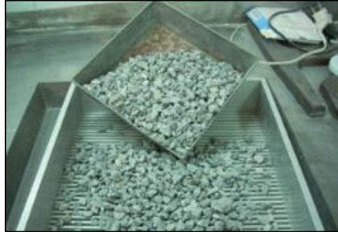
Figura 27: Separación del material por tamices de barras
