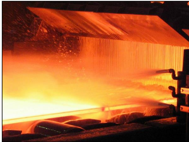
Figura 7: Proceso de descascarillado de la banda
