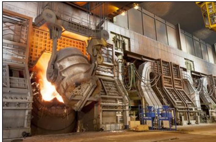
Figura 6: Carga de arrabio en el convertidor
