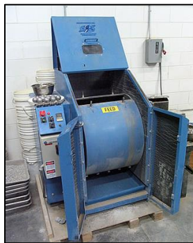
Figura 28: Detalle de equipamiento para realizar en ensayo de Los Angeles
