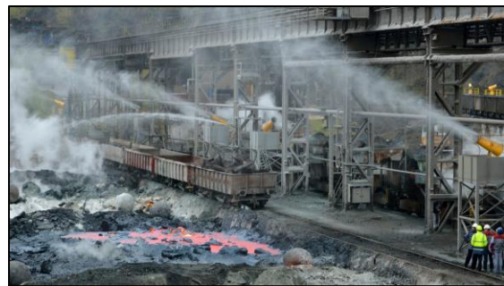
Figura 15: Volcado de escorias en foso (izquierda) y regado de escorias con agua (derecha) FUENTES: http://buildindustrialpakistan.blogspot.com/2014/03/ld-converter-slag-disposal-facilities.html y https://www.hennlich-engineering.com/applications/fog-cannons/steel-slag.html
