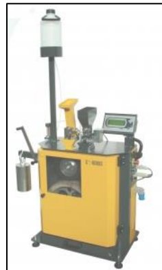
Figura 29: Máquina empleada para determinar el CPA
