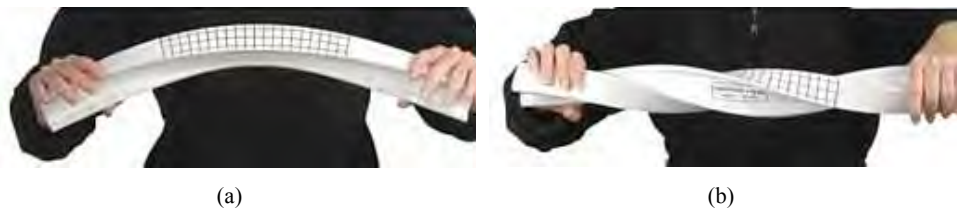
Figura 1 Viga extra-flexible Pasco mostrando pandeo lateral (a) y torsión de alabeo (b)
