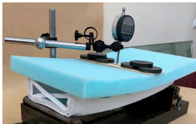
Figura 7 Modelo de puente mixto en carga.
