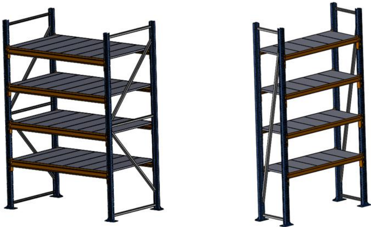
Ilustración 2.5. Ejemplos de Rack selectivo con distintos arriostrados en el bastidor.
