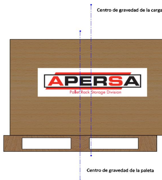
Ilustración 3.5. Excentricidad entre los centroides de la paleta y el bulto.
