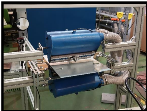
Figura 47: Colectores de Soplado y vista detalle de la placa y el baffle.
