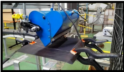
Figura 66: Cuchilla y manta de presiones para la verificación del soplado.
