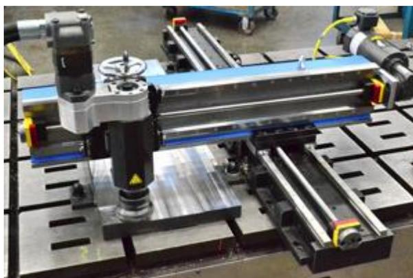
Figura 5.5- Fresadora con anclaje manual de Climax.
