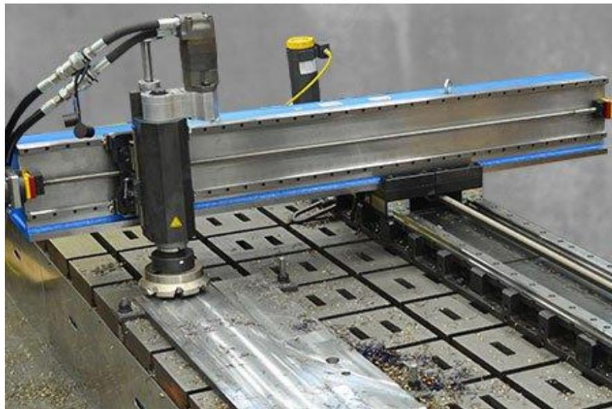
Figura 5.4- Fresadora portátil LM62000 de Climax.
