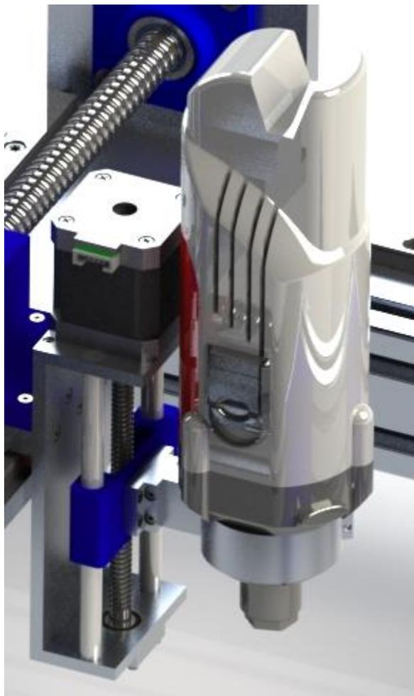
Figura 8.15- Tornillo sin fin para el desplazamiento en z.
