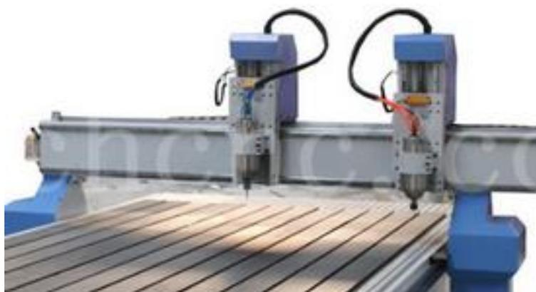
Figura 7.7- Ejemplo de un dispositivo de mecanizado con dos husillos.
