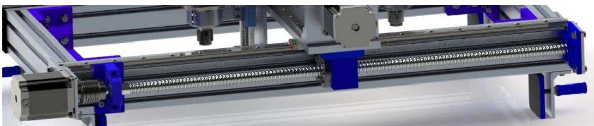
Figura 8.8- Tornillo sin fin para el desplazamiento en x.
