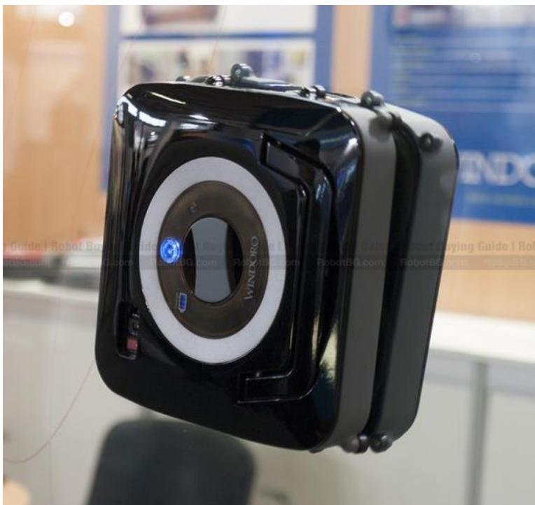
Figura 5.7- Máquina para la limpieza de cristales Windoro.
