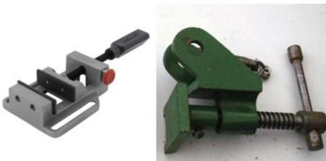
Figura 7.4- Ejemplos de elementos de apriete.
