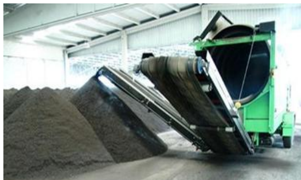
Figura 7. Máquina encargada del cribado y afino del compost, tromel
