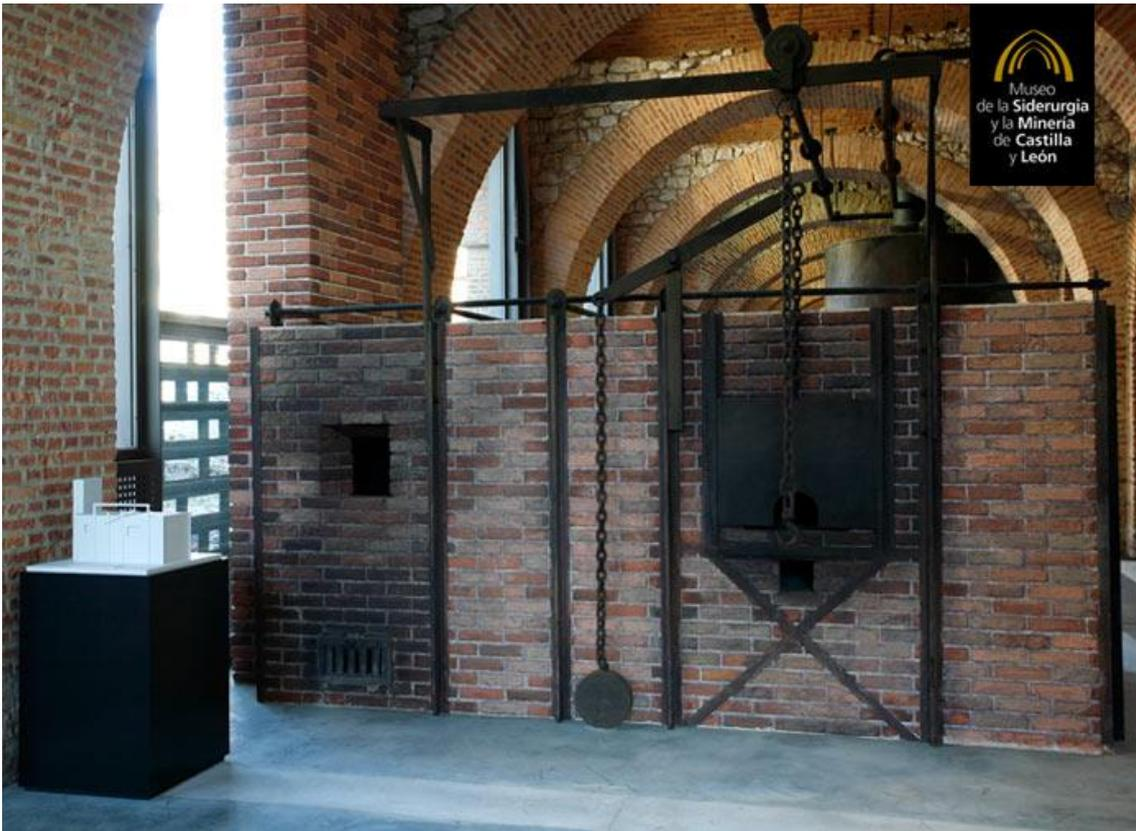
*Figura 4. Horno de Pudelado o Reverbero (Museo de la Siderurgia y la Minería de Castilla y León, s.f.)*
