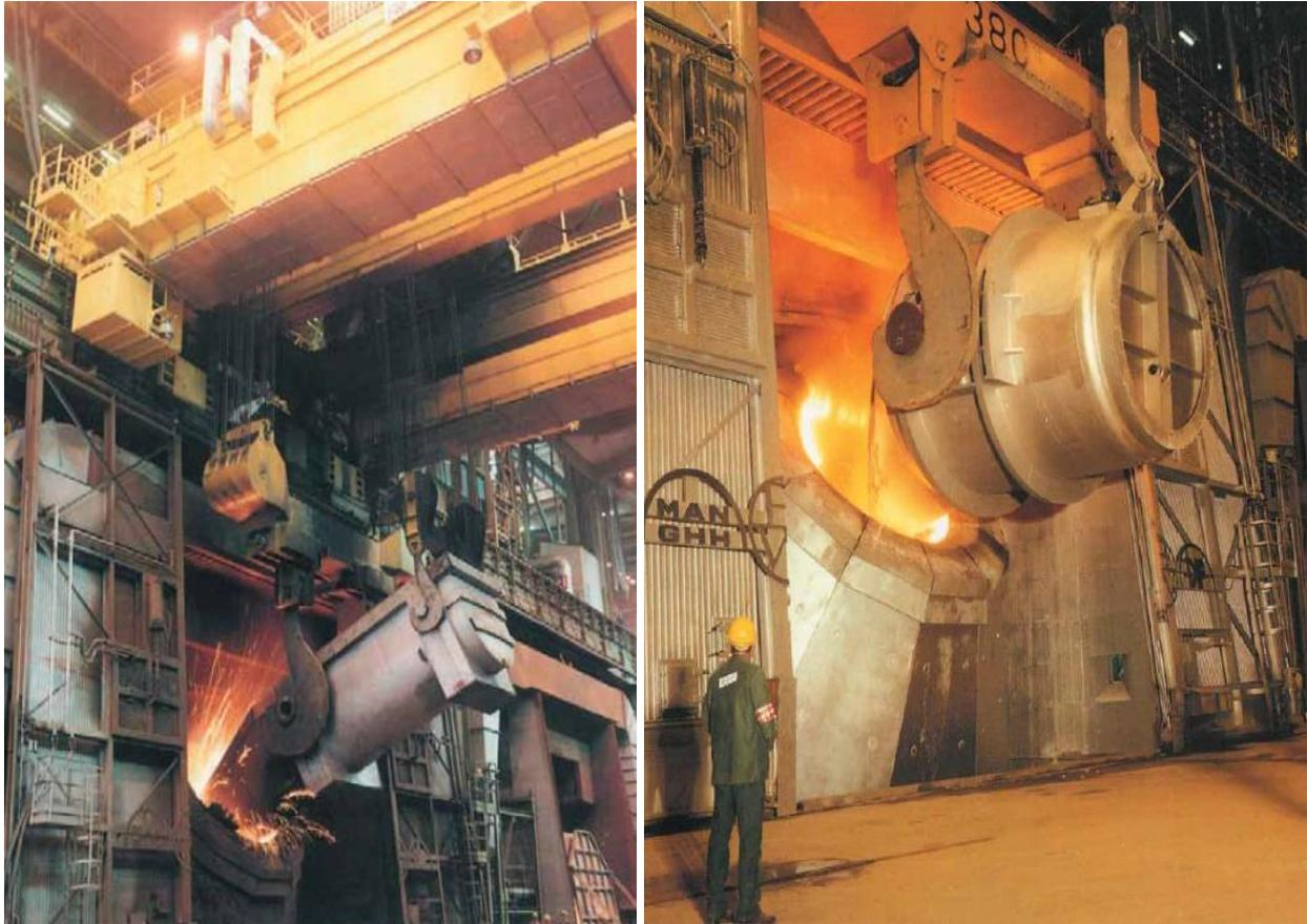
*Figura 20. Carga del Convertidor. (ETCF Arcelor Mittal Asturias, 2007)*
