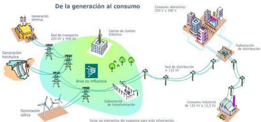
Ilustración 2. Esquema Distribución Eléctrica en España. Fuente [2]
