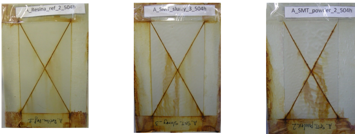
Figura 21. Probetas con recubrimiento comercial a las 500 horas de envejecimiento en niebla salina. De izquierda a derecha, probeta con resina epoxi, SMT slurry y SMT powder
