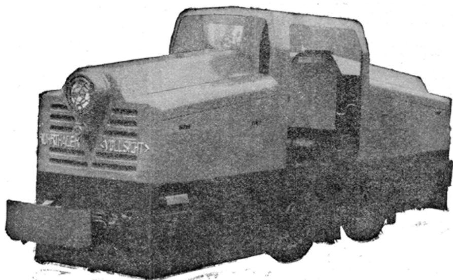
Locomotora Diesel Ruhrthal minera, con plena visibilidad, para servicio interior.
