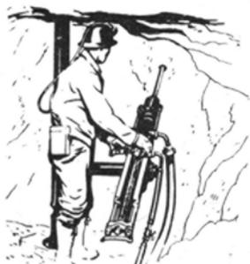
◀ **Columna de avance automático.** Este mecanismo automático de avance, hace que la barrena mantenga la presión adecuada de perforación, cualquiera que sea el tipo de roca.
