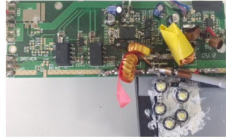
Figura 7: Prototipo del convertidor reductor CC/CC de doble fase con filtro de cuarto orden y carga con 5 HB-LEDs.
