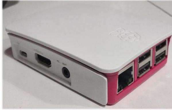
Fig. 50- Raspberry Pi 3 Model B+ con carcasa. Fuente: Elaboración Propia
