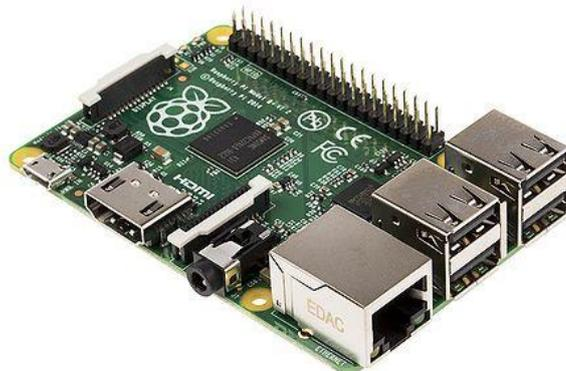
*Fig. 49- Raspberry Pi 3 Model B+. Fuente: Elaboración Propia*
