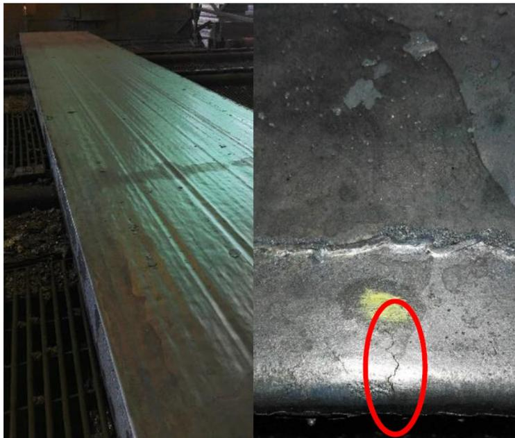
Ilustración 2.1. A la izquierda, desbaste de acero "dual phase"; a la derecha, forma típica de la grieta en la esquina de un desbaste de acero calmado al aluminio.
