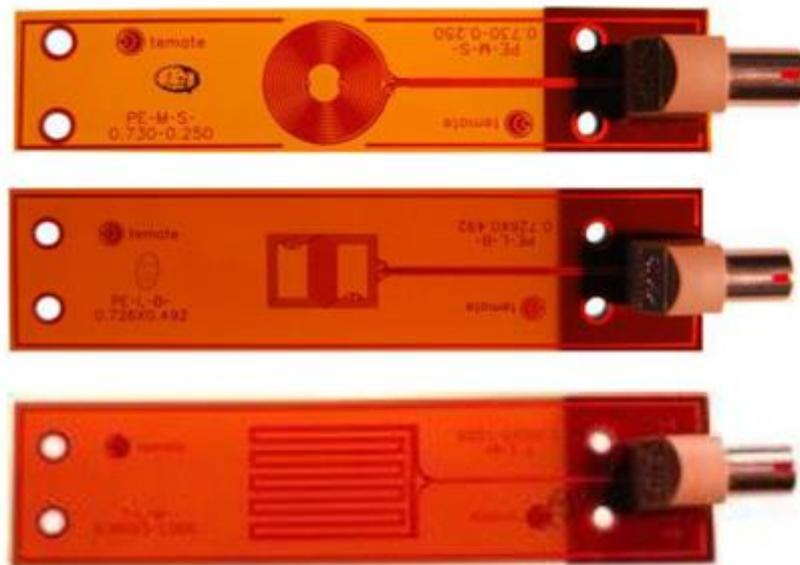
Ilustración 4.1. Geometrías habituales de bobinas EMAT. Arriba, bobina espiral; en el medio, bobina en mariposa; abajo, bobina en meandro. Fuente: Standard Sensors & Accesorios for EMAT Applications [Innerspec 2016b].
