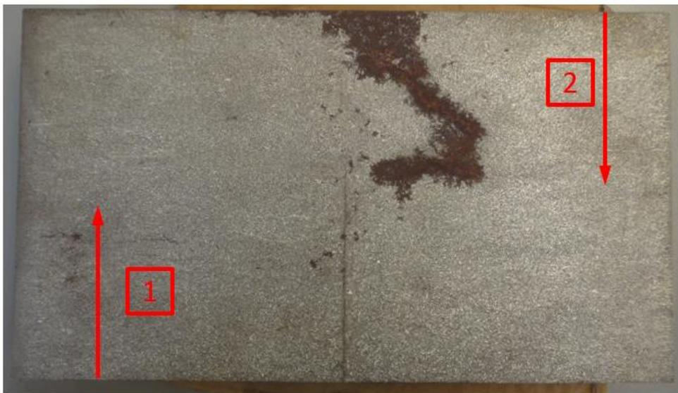
Ilustración 4.7. Posición aproximada de las direcciones de desplazamiento del sensor en cada una de las medidas realizadas en la muestra IT-4198-C.
