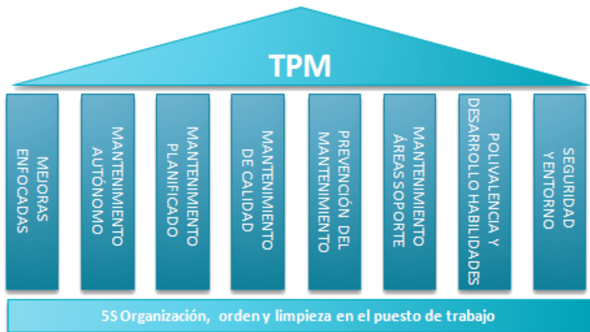
Ilustración sobre los pilares del TPM
